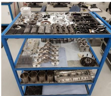
В различных классах гонок компания Gibson Technology производит и обслуживает около 80 двигателей в год, и каждый двигатель состоит из примерно 3500 деталей, каждая из которых должна иметь маркировку. Сложность была также в том, что Gibson Technology была необходима возможность маркировать любой материал - от углеродного волокна, титана и стали до алюминия и пластика различных форм и размеров.
